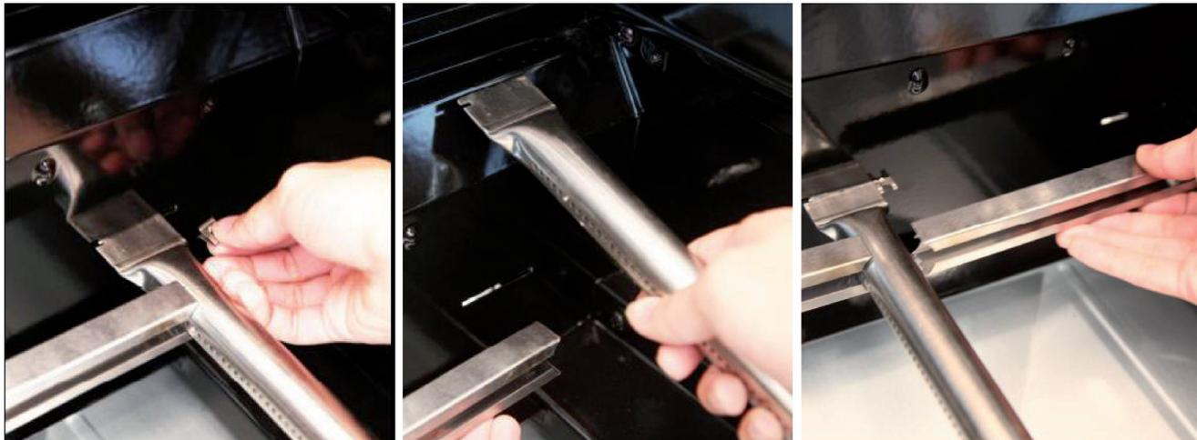
2. Wiederholen Sie Schritt 1, von rechts nach links, bis sie zum defekten Brenner gelangen.
