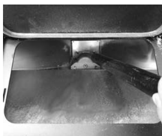
Fig. 35 - Nettoyage réservoir et vis sans fin
