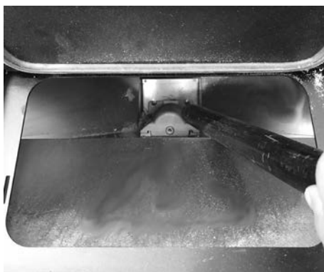
Fig. 35 - Pulizia serbatoio e codea
