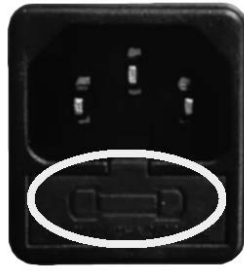
Fig. 35 - Abdeckklappe mit Sicherungen, die ausgewechselt werden müssen
