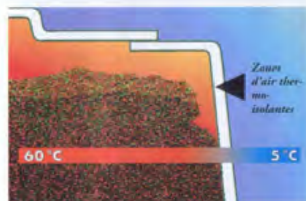
L'isolation des thermo-compostières HANDY assure des températures de fermentation idéales, même en hiver.
