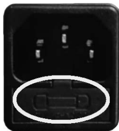
Fig. 72 - Abdeckklappe mit Sicherungen, die ausgewechselt werden müssen
