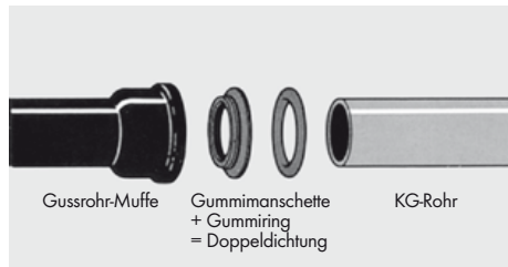
KG-Anschluss an Gussrohr-Muffe mit Doppeldichtung
