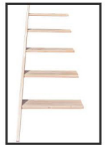
3. Stufen verschrauben und verleimen
