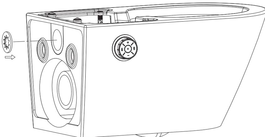
Wenn nach dem Einbau des Staeinsatzes nicht gut gespült wird, schneiden Sie einen oder mehrere Zähne des Staeinsatzes ab.
