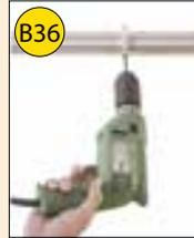
1. Befestigungspunkt anreißen, Bohrlehre auf diesen Punkt ausrichten, festklemmen und Loch  $\varnothing 5\text{mm}$  bohren
