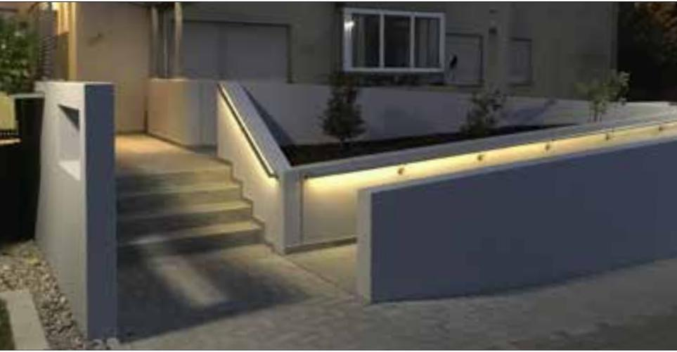
Das LightRail System besteht aus einem Nutrohrhandlauf in Edelstahl V2A oder Aluminium eloxiert, an der Unterseite befindet sich eine durchlaufende Lichtleiste, die mit sparsamen LED's betrieben wird. Das System ist sowohl für den Innen- und Außenbereich geeignet. Beleuchtung des Handlaufs mit durchgehendem LED-Band in weiß, der Betrieb erfolgt über 220V-Stromanschluss mit Steckernetzgerät.
