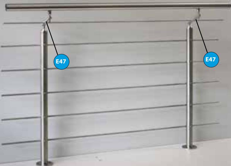
Der **Überkletterschutz E47** verhindert den gefährlichen „Klettereffekt“ bei Kleinkindern. Bei Montage benötigen Sie eine zusätzliche Edelstahlstange  $\varnothing 10\text{mm}$  zum Lückenschluss am Geländerkopf.
