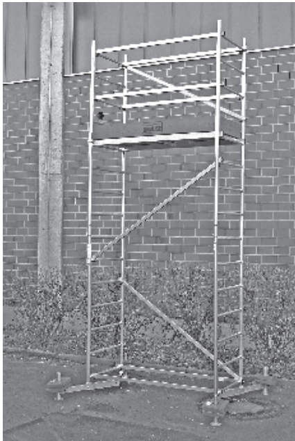
Die Abbildung zeigt das fertig montierte Gerüst mit erster Aufstockung und 8 Ballastgewichten
